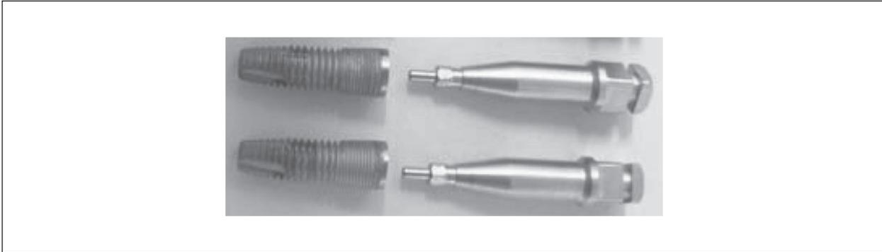
Figura 12 – Imagem das amostras, após ensaio de torção.
